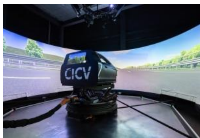
图 0.9 绳索式高动态驾驶模拟器
