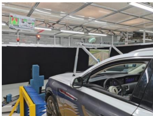
图 0.8 面向智能驾驶动态场景测试的车辆在环平台
