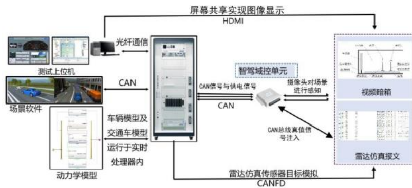
图 0.5 江淮汽车智驾系统 HIL 仿真测试技术方案
