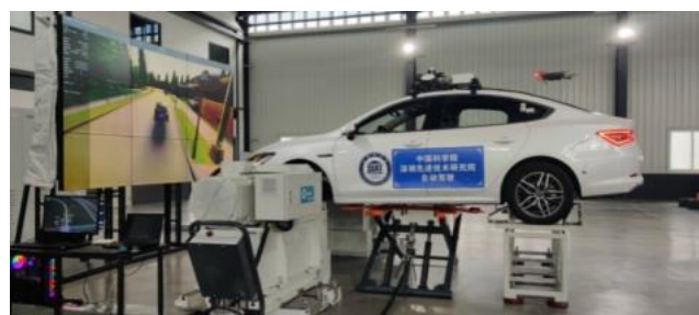
图 0.7 智能驾驶整车在环测试系统
