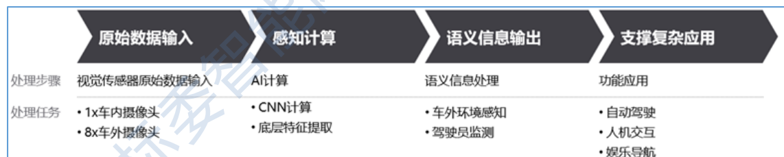
图 10 Tesla Autopilot 数据流处理机制
