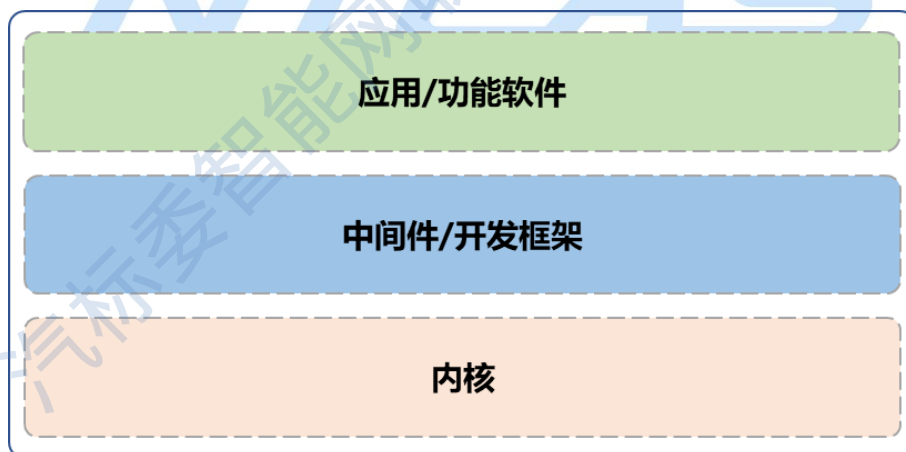
图 6 智能驾驶操作系统纵向分层示意图
