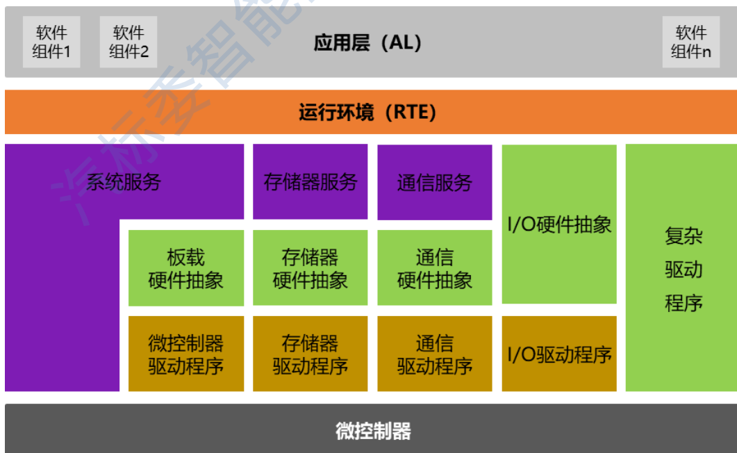
图 5 Classic AUTOSAR 软件架构
